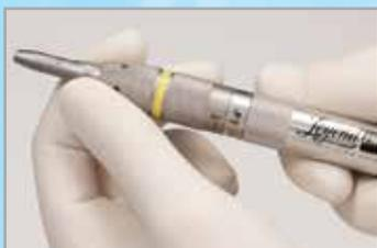
Установите насадку на мотор и совместите треугольные метки на насадке с треугольными метками на корпусе мотора до ощутимого щелчка.
