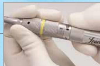
Поверните насадку в положение блокировки, обозначенное закрытым замком (🔒) на корпусе мотора. Убедитесь в том, что треугольная метка на насадке совмещена со значком закрытого замка; это будет означать, что насадка установлена верно и заблокирована. Убедитесь в том, что режущий инструмент установлен верно и заблокирован. Для этого слегка потяните за него.
