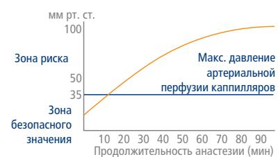
Повышение внутриманжетного давления во время анестезии с применением N<sub>2</sub>O при использовании традиционной эндотрахеальной трубы, без ручной коррекции внутриманжетного давления.
